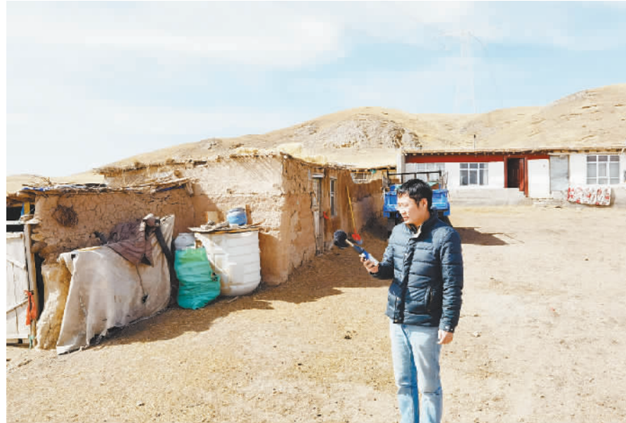
图为工作人员正在进行输电线路敏感目标噪声监测。 浙江省生态环境厅供图
