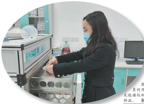
图为工作人员利用X射线荧光能谱仪测量古陶瓷样品。孙合杨摄
