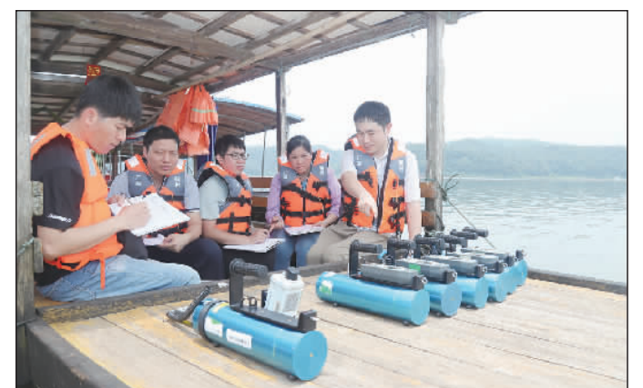
为提升全区核与辐射监测人员能力水平,广西壮族自治区近日组织全区来自14个地市的共50多名核与辐射监测技术人员开展X-γ辐射剂量率现场比对业务培训工作。图为监测人员正在开展水上FH40C型X-γ剂量率仪比对。 高德年摄
