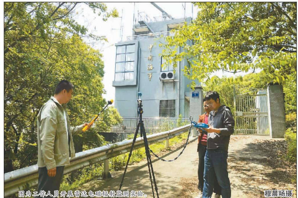
图为工作人员开展雷达电磁辐射监测实验。
