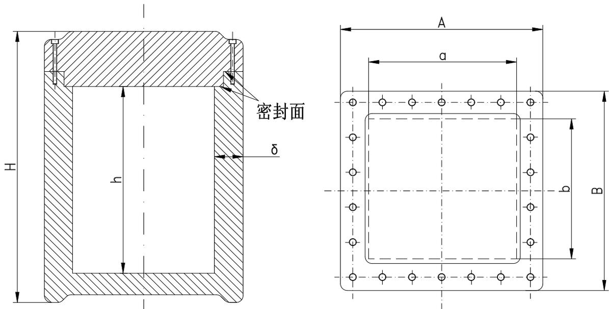
图 B.1 箱型球墨铸铁容器结构示意图
