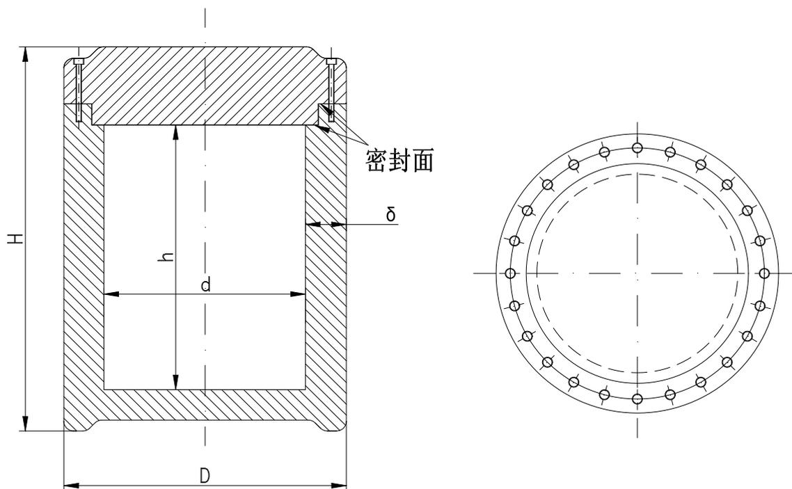
图 B.2 桶型球墨铸铁容器结构示意图
